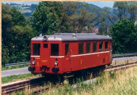
■ Motorový vagón s kabínkami pre vodiča na oboch stranách
